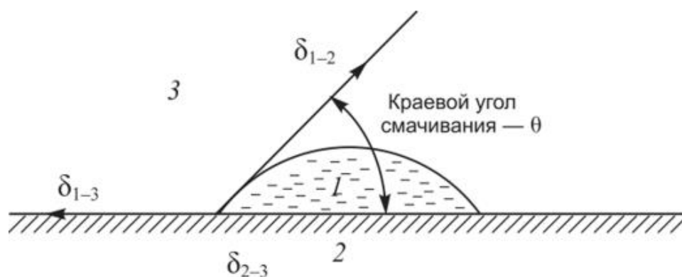
Рис. 1. Определение краевого угла смачивания
